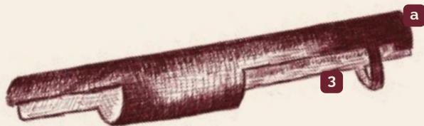
**3 Verbindungsstück** - dies ist ein kleineres Rohr mit Aussparungen, die genau in die vorbereiteten Öffnungen im Brennstoffbehälter (höherer Zylinder) passen.
